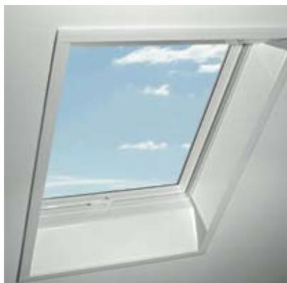
**Система внутренних откосов из ПВХ** обеспечивает функциональное и безошибочное соединение мансардного окна с внутренней отделкой. Гибкие панели из ПВХ легко мнутся и абсолютно влагостойкие. Откосы монтируются к мансардному окну на защелках. Благодаря этому их можно в любой момент снять и после осмотра соединения окна и кровли (самого ответственного места кровельного пирога), легко установить на прежнее место.
