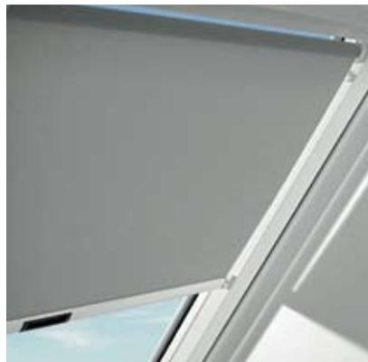
**Солнцезащитные рулонные шторы в версии Стандарт (SOROLLO и ZRS).** Фиксируются в 3-х позициях на крючках. Версия SOROLLO исключает возможность управления шторкой при помощи телескопического стержня Roto.
